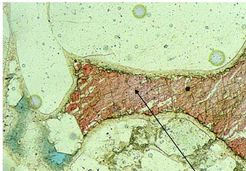
niska przepuszczalność – wiele porów zaklejonych
